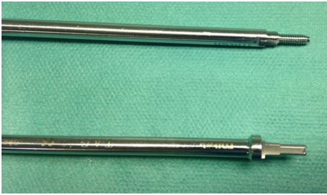
Abb. 2 ▲ Kanülierter Stufenbohrer (unten) und Gewindeschneider (oben) für Anlage der Bohrlöcher durch das Korakoid
